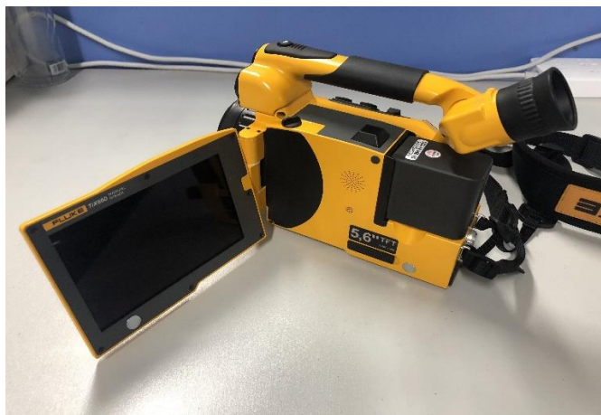
图 5.8 Fluke Tix660 手持式红外热成像仪
